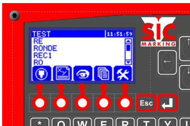
Пять функциональных клавиш активируют контекстные меню, обозначенные пиктограммами на панели инструментов
