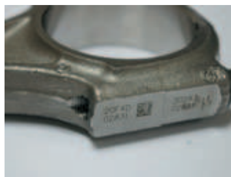
Маркировка шатуна
