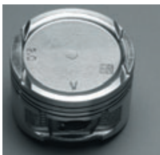
Код Data Matrix на поршне
