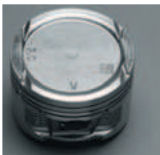
Код Data Matrix на поршне
