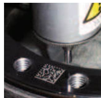
Маркировка детали 2D-кодом
