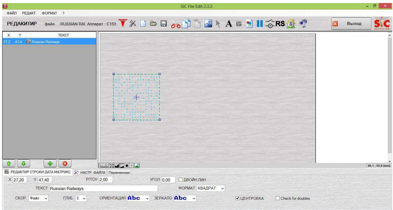
Таким образом маркировочные файлы могут быть созданы на компьютере заранее, в отсутствие возможности подключения к контроллеру. Маркировочные файлы в программе **SIC File Edit** могут создаваться для различных моделей оборудования SIC Marking и копироваться в контроллер маркировочного оборудования в любое удобное время.
