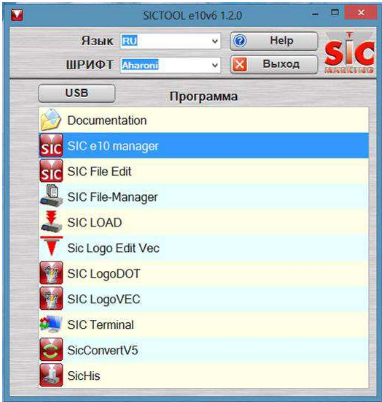
Программное обеспечение **SICTOOL** состоит из 10 программных продуктов, каждый из которых предназначен для решения определенной задачи. Все программы русифицированы и устанавливаются одним пакетом. Установка программного обеспечения на компьютер очень проста и не требует специальных навыков. После установки **SICTOOL** в поле **Language** выберите **RU**. Ваш интерфейс переключится на русский язык.
