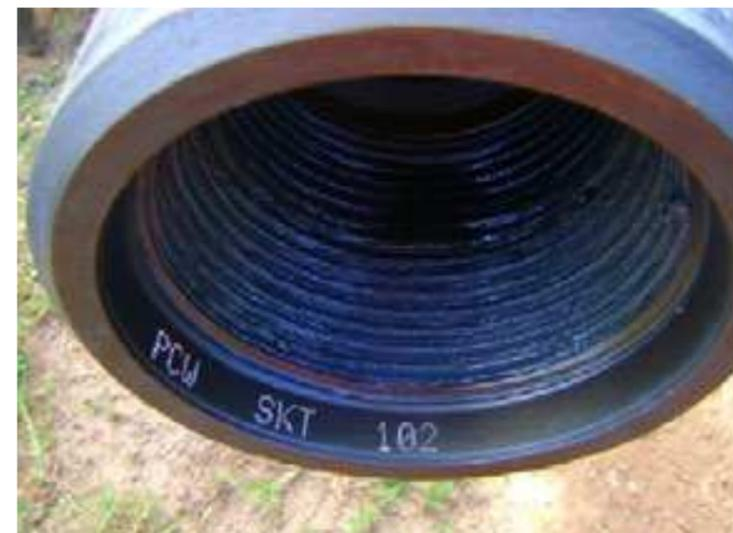
Маркировка представляет собой последовательность точек, формируемых на поверхности трубы маркировочной иглой. Полученная маркировка не нарушает геометрии резьбы и не снижает прочностных характеристик замка трубы
