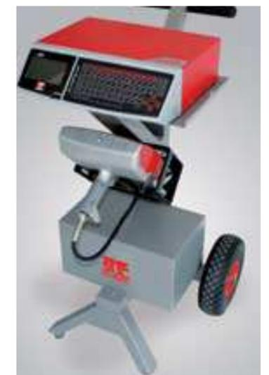
Для мобильности комплекта используется специальная тележка, с размещённым контроллером управления маркиратором и маркировочной головкой р62
